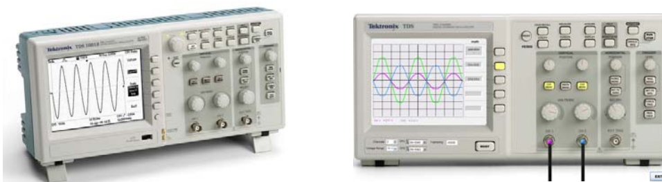
Slika 1: Izgled fizičkog i VI Osciloskopa firme Tektronix serija TDS 1000
