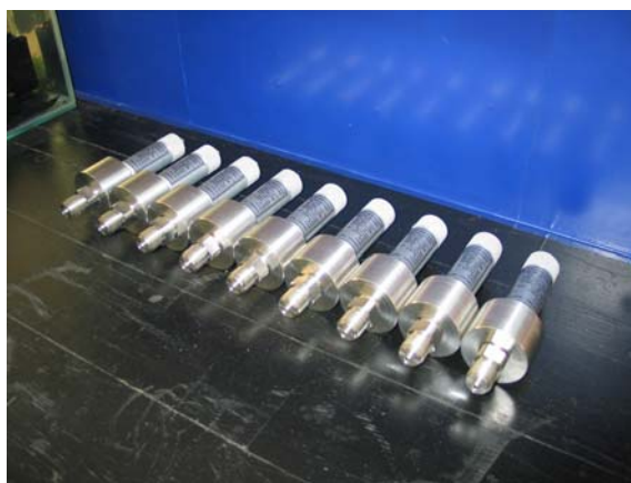
Slika 1: Realizovana mala serija transmitera TPa/r-101
