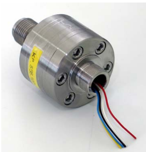
Slika 3: Transdjuser pritiska MKa/r-101
